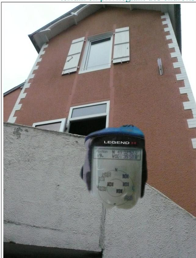
Précision de  $\pm 9\text{ m}$  à coté d'une maison de grande hauteur réduisant l'accès au signal satellite
